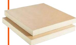
**Panneau de mousse rigide de polyisocyanurate (PIR) revêtu des deux faces par un complexe multicouches de Kraft aluminium.** La haute résistance thermique est parmi ses caractéristiques principales, permettant d'utiliser des panneaux isolants d'une épaisseur inférieure, sa rigidité et sa légèreté facilitent sa manipulation et mise en œuvre.
