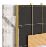
Pare-pluie noir résistant aux UV pour durées d'exposition aux intempéries élevées et bardages à joints fermés ou légèrement ajourés (≤ 10 mm et 10 %).
