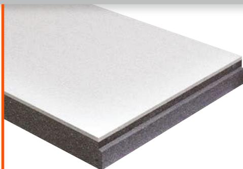
Panneau associant un isolant en polystyrène expansé graphité à bords rainurés de très forte densité et un parement en plaque de ciment de 8 mm d'épaisseur, dédié à l'isolation thermique et la protection mécanique des parties apparentes des murs de soubassement.
