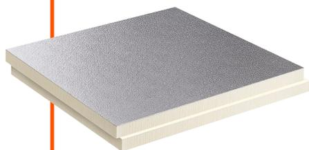
Powerdeck®+ est un panneau d'isolation thermique. Son âme est constitué de mousse TAUfoam (mousse de polyisocyanurate rigide PIR). Le panneau est revêtu par un film en aluminium gaufré sur ces 2 faces, à bords droits ou feuillurés.
